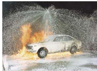
泡沫喷淋系统
