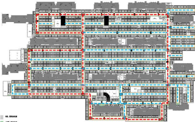
✓ 大车库主流线设置为环形，宜链接各坡道出入口
