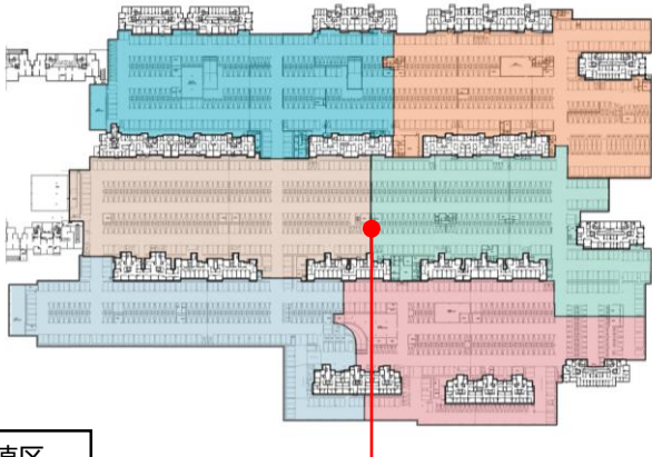
防火分区宜与地库行车道垂直划分，并远离行车道拐弯处
